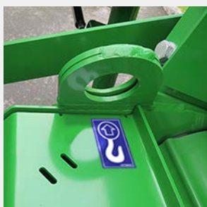
Løftekrok høyre side
