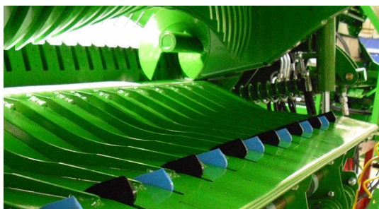
Modus for fjerning av blokkering, knivene tilbake og kanalgulvet senket
