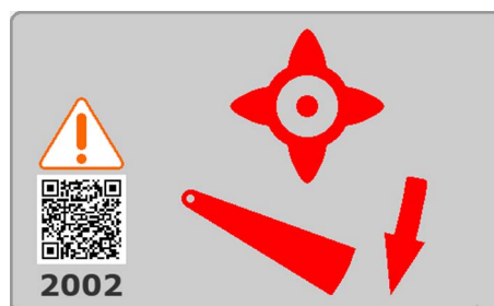
Advarsel om at gulvet er nede
