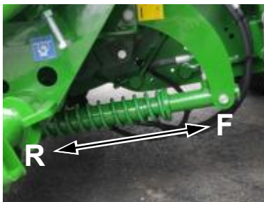
Justering av flytende fjæring til pick-up
