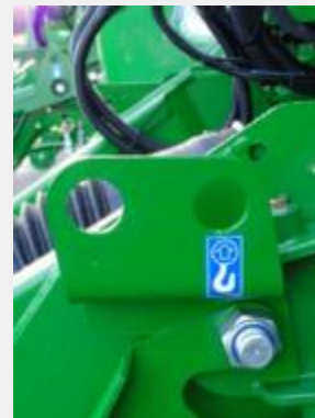
Løfteøk venstre side
