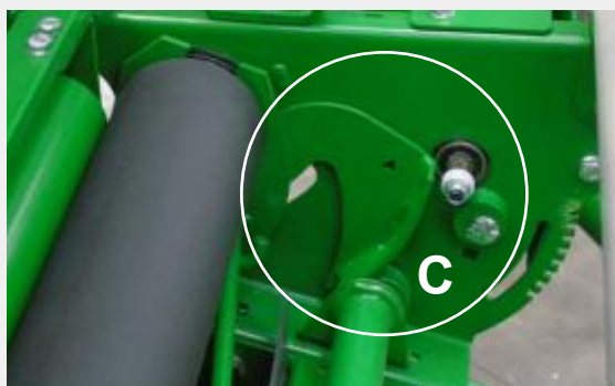
Kniven løste ut (eldre maskiner)
