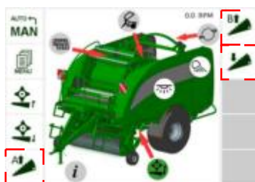
Valgbar drift av knivene (manuell)
