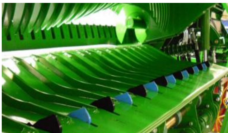
Modus for fjerning av blokkering, knivene tilbake og kanalgulvet senket
