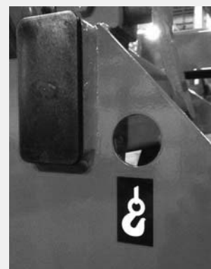
Bakre løfteøkrok høyre side
