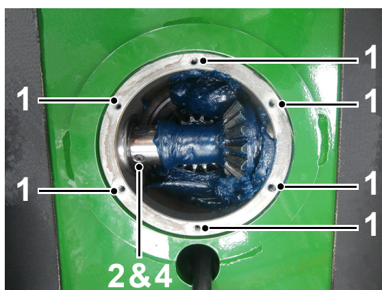
Utskifting av splint på girassens tverraksel
