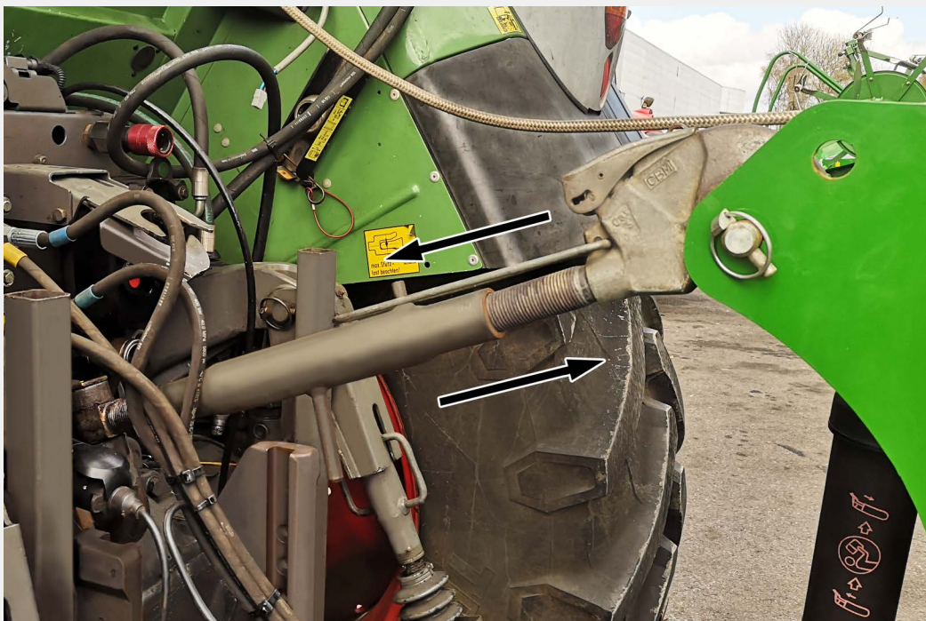
Justering av toppleddet for å endre chassis og rotorvinkel
