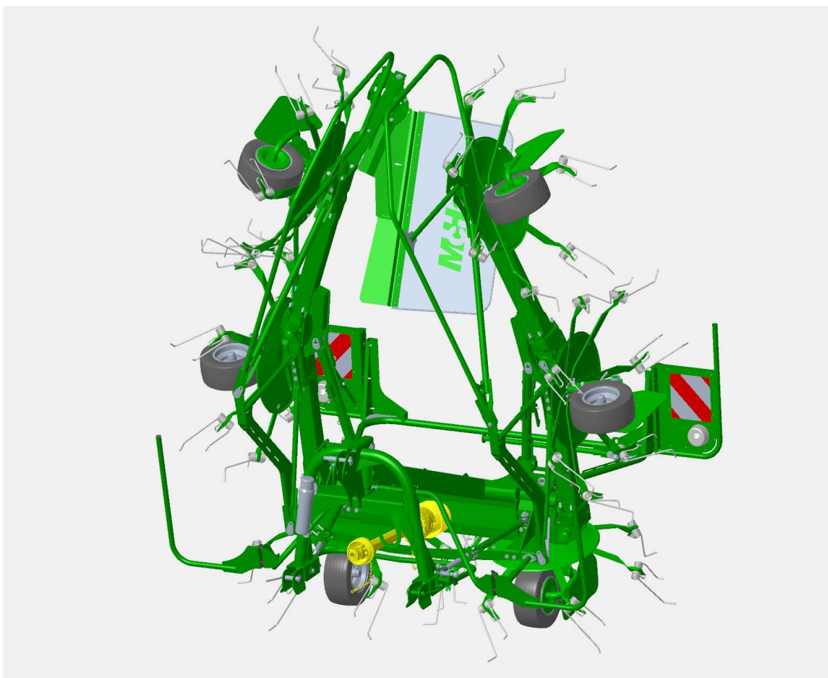
Posisjon under veitransport (Rotorarmer og ben står i hevet stilling)
